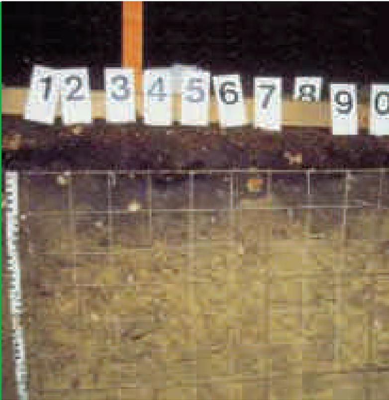
Bild 24: Wurzelzählung an der Bodenprofilwand
